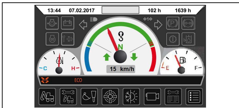
Bild 5-45 Display vid aktiverad överlastvarning
