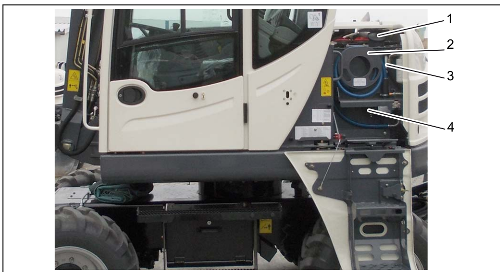
Bild 6-14 Fyll på bränsle med hjälp av den elektriska bränslepumpen (tillval)
