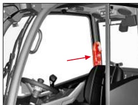
Bild. 4: Monteringsplats för brandsläckare
