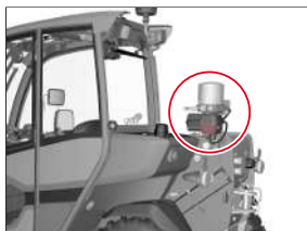
Bild. 237: Positionering av centralsmörjsystemet i fordonet
